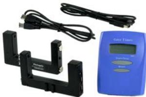
Das Set besteht aus: 1 x Zeitählgerät digital, 2 x Gabellichtschranken und 2 x Verbindungskabel
